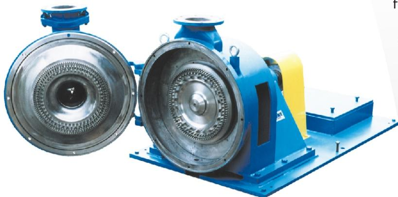
Os discos dos despastilhadores da série HD possuem uma forma construtiva do tipo "dentes envoltentes", fabricados em aço inox fundido, em segmentos de diferentes áreas de passagem, possibilitando o "despastilhamento" absoluto da massa, com a menor variação do grau Shoper Riegler.
